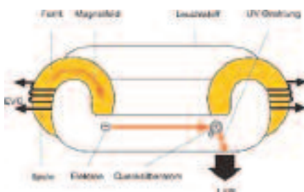
2 Funktionsprinzip der OSRAM Endura Induktionslampe
