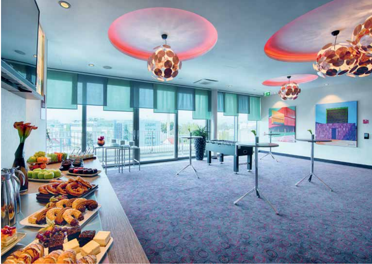
Abb.: Die mit kupferfarbenen Scheiben auffällig gestalteten Pendelleuchten sind die Eyecatcher in der Coffee Break Area. Kreisförmige Voutenbeleuchtung mit RGB-LED Streifen und Downlights sorgen für die allgemeine Raumbelichtung.
